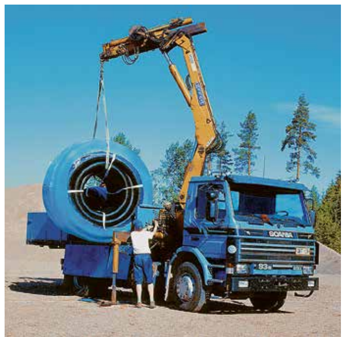
Entladung mit LKW-Ladekran und Textilgurten (min. 50 mm breit).
